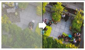
Wenn die Sicht durch Nebel oder Rauch beeinträchtigt wird, passt diese Funktion die Werte für Farbe, Kontrast und Kantenschärfe an, um ein klareres Bild zu erhalten.
