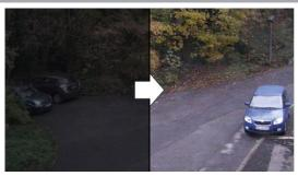
Die dynamische Verstärkungsregelung (auch Gain Control genannt) ist ein elektronischer Schaltkreis, den man gewöhnlich in Kameras vorfindet, die das Videosignal bei schwachen Lichtverhältnissen verstärken. Bei normalem Betrieb sorgt sie für einen konstanten Verstärkungsfaktor.
