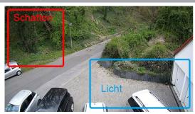
Details sowohl in dunklen als auch in hellen Bildbereichen kommen besser zur Geltung. Dadurch, dass die einzelnen Objektbereiche in einer Szene von der Kamera unterschiedlich belichtet werden, sind die Objekte in den hellen sowie in den dunklen Bereichen sichtbar.
